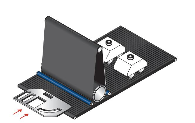
Entgratung, allseitig gleichmäßige Kantenverrundung und Oberflächenschleifen von Blechen im Trockenverfahren
