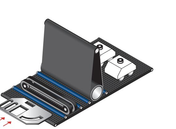
Mechanische Schlackeentfernung, Entgratung und Kantenverrundung von Blechen im Trockenverfahren
