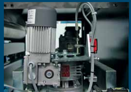
Motorisierte Höhenverstellung der Bürstenaggregate / motorized head adjustment for the brush heads
