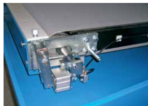
Automatische Transportbandsteuerung / Automatic conveyor belt tracking
