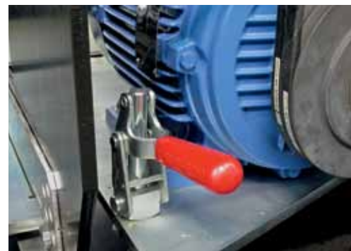
Einfaches Herausnehmen der Motoren / Easy displacement of the motors
