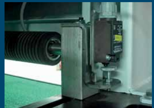
Schutzrolle für Überdicke / Over thickness protection roller
