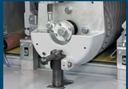
Automatische Aggregatverriegelung / Automatic head lock
