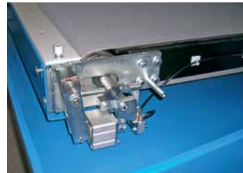
Automatische Transportbandsteuerung / Automatic conveyor belt tracking
