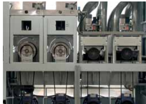
Zentrales Schmiersystem (Antriebsseite) / Drive motor side
